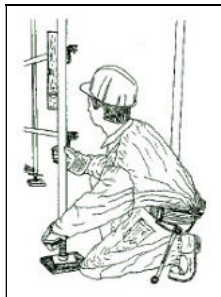
11. Comprovació de l'anivellament vertical
